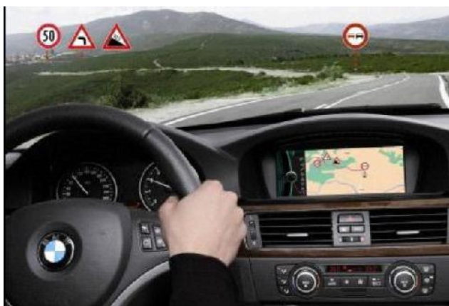
Slika 11 - Sistem za automatsko prepoznavanje znakova (Izvor: Vukanović S., (2014) "Inteligentni transportni sistemi u drumskom saobraćaju - osnove", Saobraćajni fakultet Beograd)
