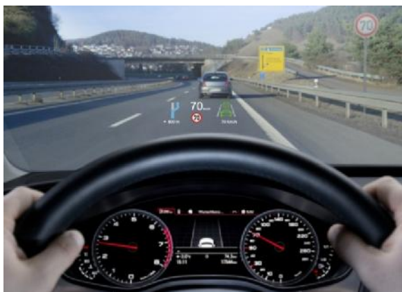
Slika 13 - HUD sa informacijama o maksimalnoj dozvoljenoj brzini, trenutnoj brzini i isključenju sa glavnog puta za 800 m (Izvor: www.automotiveworld.com )
