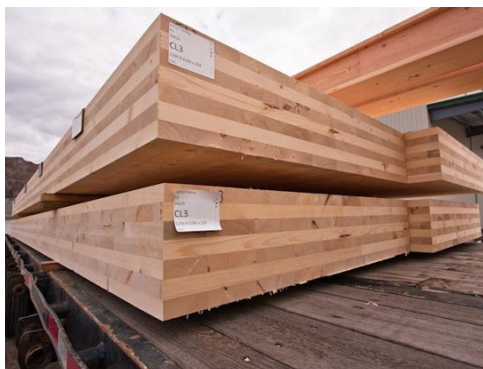
Слика 1. Унакрсно ламелиран дрвени панел
