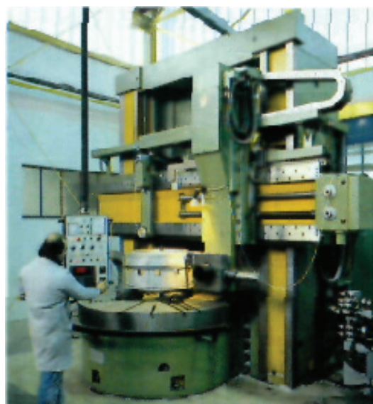
Slika 2. Specijalno vertikalno postrojenje za presovanje sunderastih materijala
