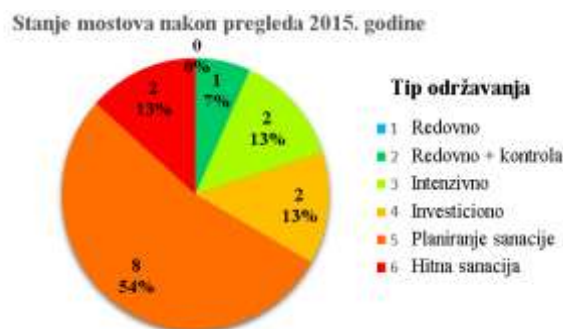
Slika 5. Broj i procenat mostova za svaki tip održavanja nakon pregleda 2015. godine Figure 5. Number and percentage of bridges for each type of maintenance after 2015 inspection
