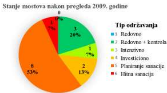
Slika 4. Broj i procenat mostova za svaki tip održavanja nakon pregleda 2009. godine Figure 4. Number and percentage of bridges for each type of maintenance after 2009 inspection
