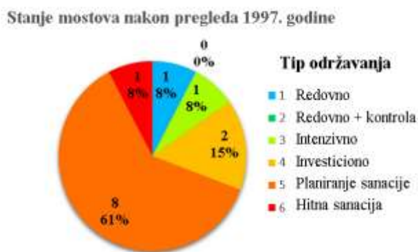
Slika 2. Broj i procenat mostova za svaki tip održavanja nakon pregleda 1997. godine Figure 2. Number and percentage of bridges for each type of maintenance after 1997 inspection
