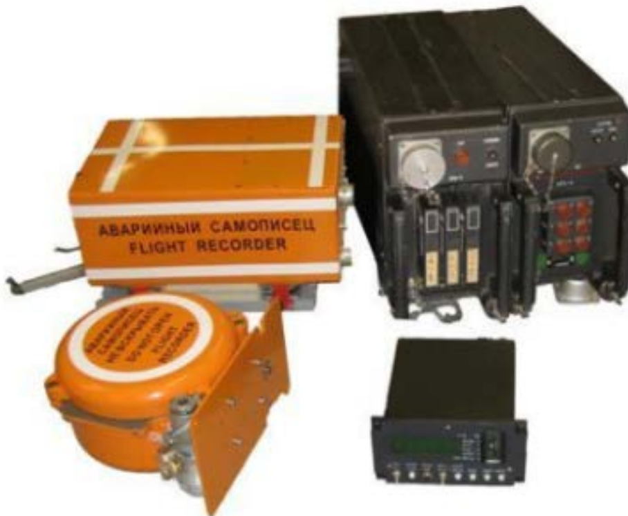
Figure 6 – Flight parameters recorder BUR-1-2 of the Mi-17V-5 helicopter Рис. 6 – Регистратор параметров полета БУР-1-2 вертолета Ми-17В-5 Слика 6 – Регистратор параметара лета БУР-1-2 хеликоптера Ми-17В-5 (in Serbian)
