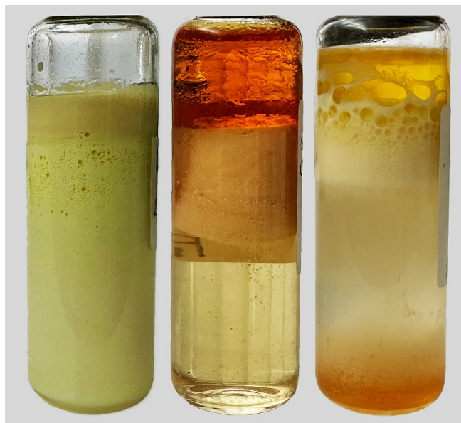
Figure 2. Visual observation of emulsion destabilization phenomena Slika 2. Vizuelno opažanje fenomena destabilizacije emulzija
