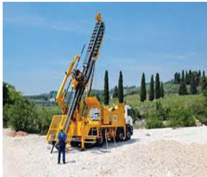
Слика 7, Тип иарнићуре за истражно бушење карактеристичан за почетак XXI века (www.Wikipedia.com)
