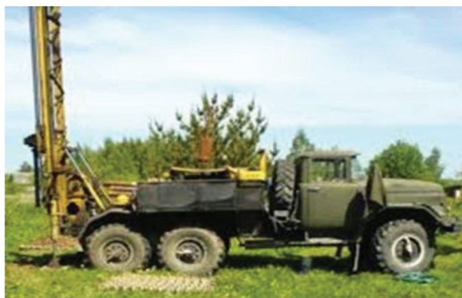
Слика 5, Тип иарнийуре за истражно бушење карактеристичан за йериод 70/80-йих йодина XX века ( www.Wikipedia.com )
