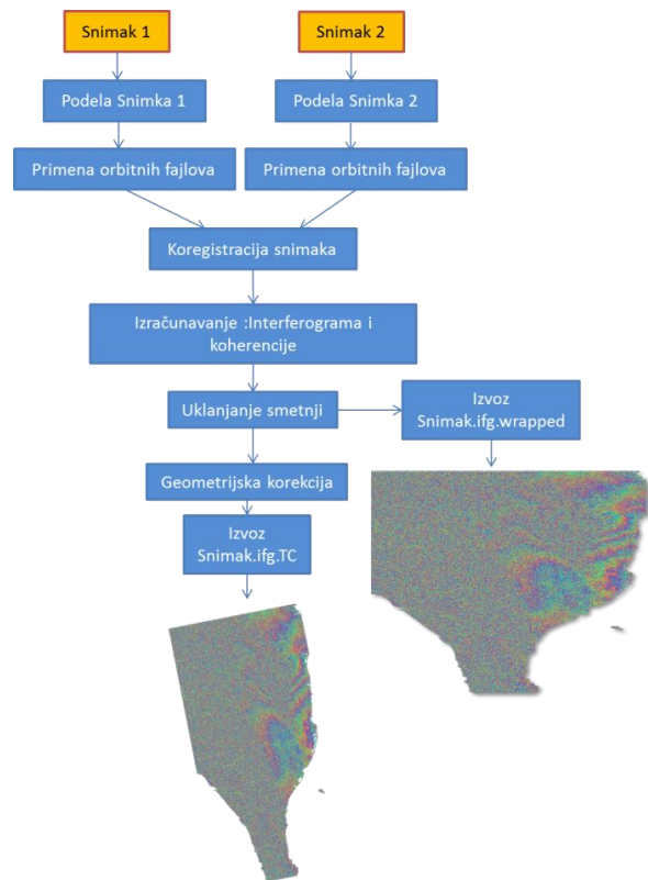
Slika 1 - Šema procesa obrade snimaka i izrade interferograma
