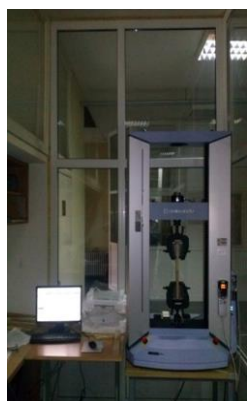
Slika 2 - Kidalica SHIMADZU tip SIL-50KNAG bukve i prikaz sile loma na probi [3]
