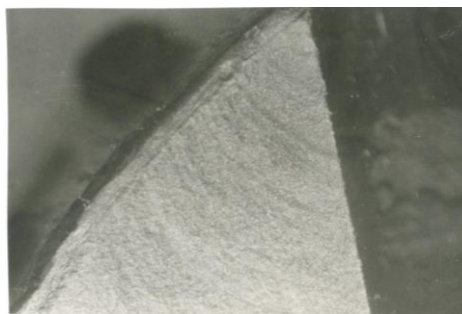
Slika 6 - Makroskopski snimak prelomne površine uzorka 1. Vidljiva je zona propagiranja pukotine, u vidu koncentričnih segmenta. Povećanje 50x [8]
