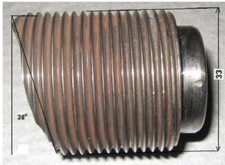
Slika 9 - Makro snimak slomljenog dela regulacionog ventila
