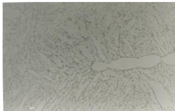
Slika 2 - Uzorak 2: Martenzitno-feritna, vidljivo opušten martenzit formiran sa koagulacijom karbida po granici 1000x [8]
