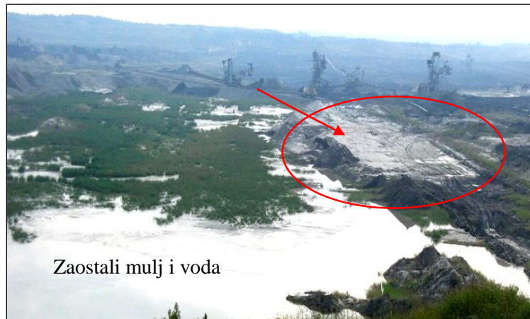
Slika 8 - Nasipanje peska u pravcu istok-zapad, duž južnog oboda muljevitih masa UO PK TZP (2016, D. Božić)
