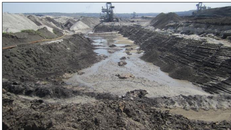
Slika 10 - Radne kosine u II sloju uglja na PK TZP, sa vrhovima od odloženih peskovitih kupa i nožicama koje su za 10 m dublje od dna močvare (17.8.2017. D. Božić)
