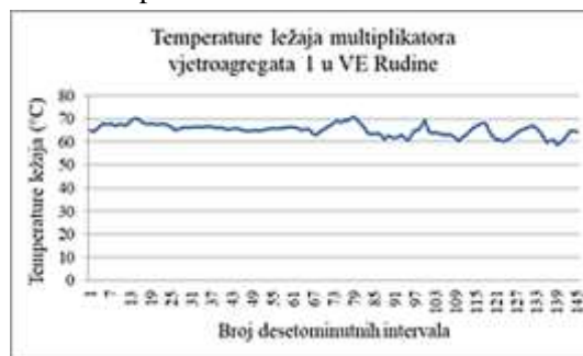
Slika 9 - Temperature ležaja multiplikatora vjetroagregata 1 u VE „Rudine“
