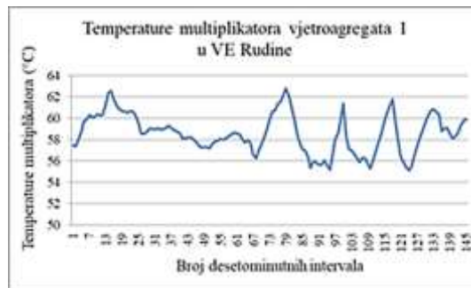
Slika 8 - Temperature multiplikatora vjetroagregata 1 u VE Rudine
