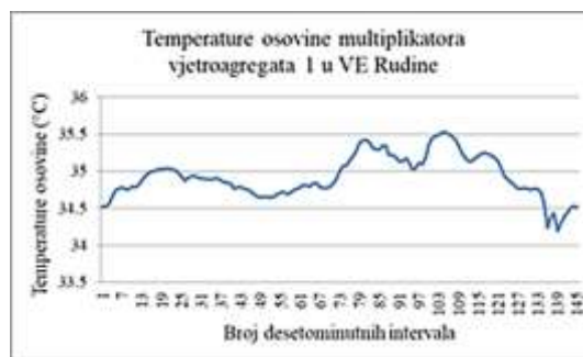
Slika 10 - Temperature osovine multiplikatora vjetroagregata 1 u VE „Rudine“
