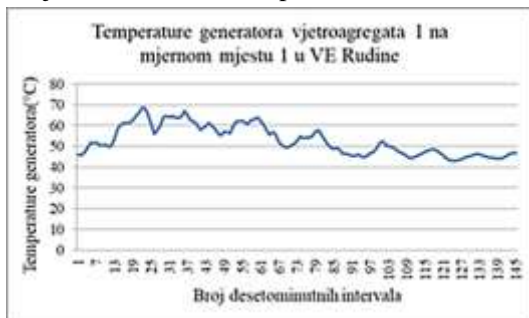
Slika 4 - Temperature generatora vjetroagregata 1 na mjernom mjestu 1 u VE Rudine
