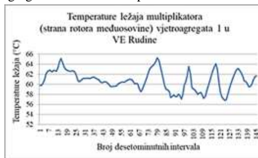
Slika 14 - Temperature ležaja multiplikatora (strana rotora međuosovine) vjetroagregata 1 u VE Rudine
