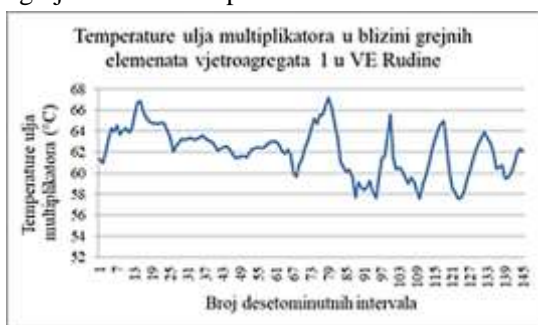
Slika 15 - Temperature ulja multiplikatora vjetroagregata 1 u VE „Rudine“ u blizini grejnih elemenata
