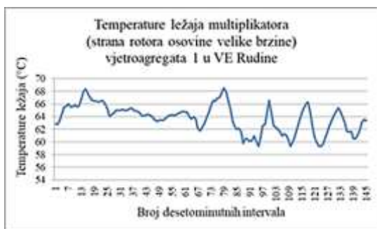
Slika 12 - Temperature ležaja multiplikatora (strana rotora osovine velike brzine) vjetroagregata 1 u VE „Rudine“
