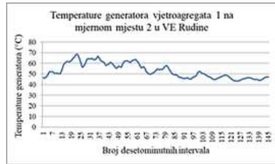
Slika 5 - Temperatura generatora vjetroagregata 1 na mjernom mjestu 2 u VE Rudine
