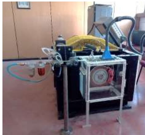
Slika 1 – BrakeDyno 2020 u procesu adaptacije za mogućnost merenja čestica
