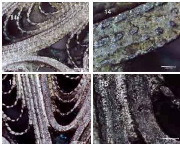
Slika 5 - Zone čišćene, \lambda=355\text{nm} , F=0,5\text{ J/cm}^2
