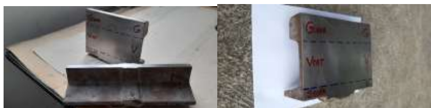
Slika 9 - Makro pregled poprečnog i uzdužnog preseka AT zavarenog spoja
