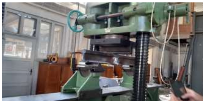
Slika 3 - Ispitivanja savijanjem zavarenog spoja na dva oslonca
