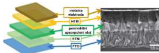
Slika 2 - Shema i SEM slika preseka PSC [25].
