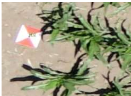
Slika 6 - Prikaz izgleda jednog kontrolnog markera
