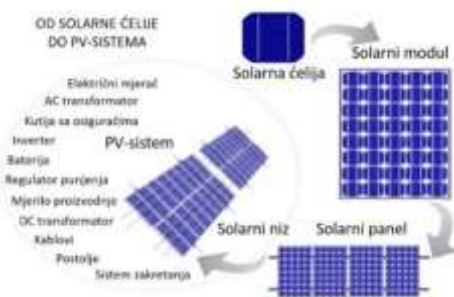
Slika 1 - Elementi i struktura fotonaponskog sistema [6]
