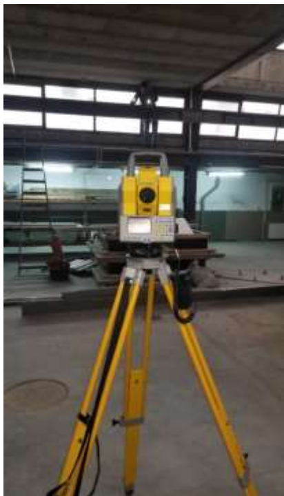
Слика 2 – Тотална станица Trimble 5500 Series у току мерења
