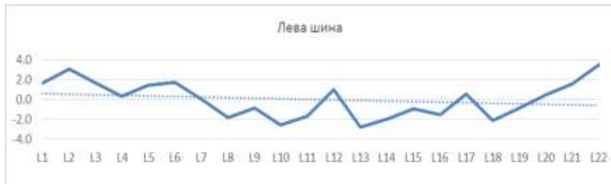
График 1 – Диспозиција тачака леве шине [mm] у односу на регресиону праву шине
