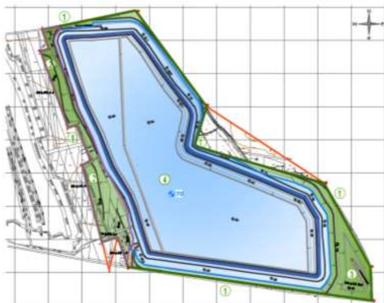
Slika 3 - Završna kontura površinskog kopa „Garajevac Istok“ i rekultivacione celine, legenda: 1. Zaštitni pojas sa zasadima drvenastih lišćarskih vrsta, L=2.500 m; 2. Horizontalne i kose površine odloženog peska (na zapadnoj strani kopa), sa zasadima drvenastih lišćarskih vrsta i šiblja; 3. Horizontalne i kose površine odloženog peska (na jugoistočnoj strani kopa), sa zasadima drvenastih vrsta; 4. Depresija površinskog kopa pretvorena u jezero, akumulacijom vode iz krovinske izdani, na koti k+70
