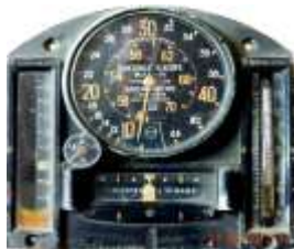
Slika 1 - Kombinovani avio instrument iz 1932. godine (iz zbirke Muzeja vazduhoplovstva u Beogradu).
