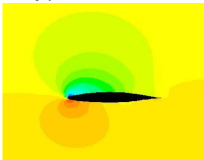
Слика 20 - Коефицијент притиска класичног крила у равни симетрије \alpha=12^\circ, V=10,7 \text{ m/s}, H=0 \text{ m}
