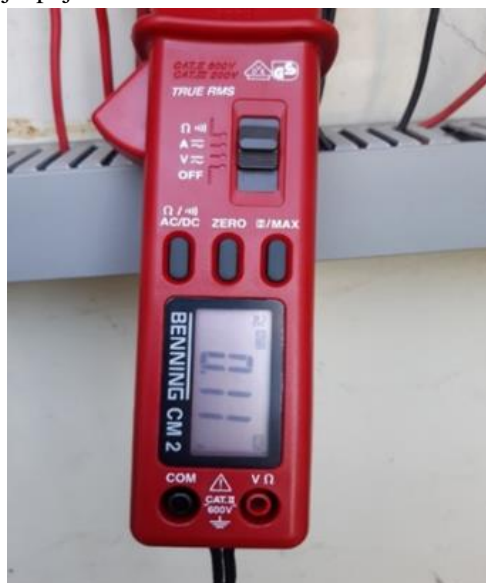
Slika 1 - Instrument sa zabeleženom strujom usled nastanka zemljospoja (Izvor: autori)
