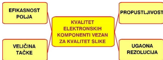
Slika 4 - Optičke i elektronske komponente koje su od uticaja na kvalitet endoskopske slike
