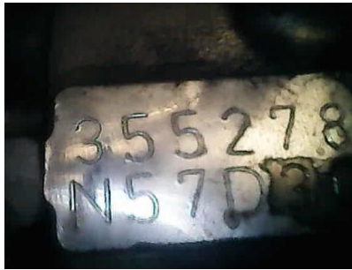
Slika 6 - Broj motora BMW X6-X drive 4.0 endoskop BOSCH profesional GIC 125 [22]
