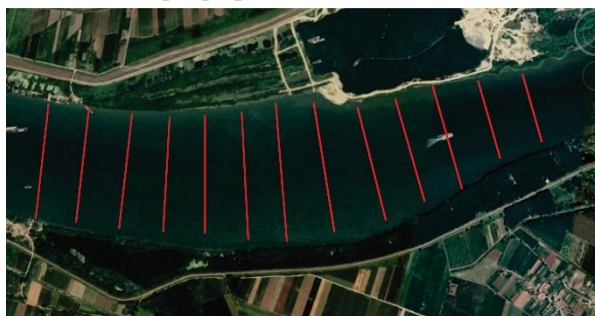
Слика 3 – Оријентациони приказ путање пловила током хидрографских мерења једноснопним дубиномером
