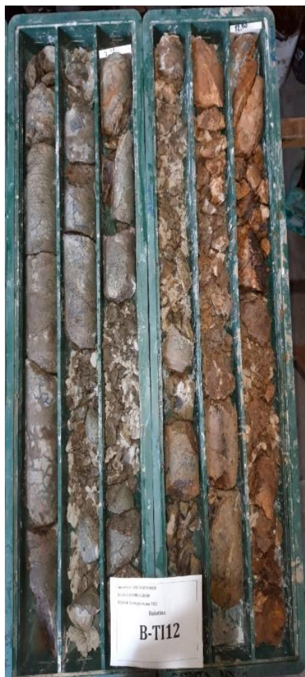
Slika 6 - Ispucalost stenske mase u zoni temelja vetroturbine TI-12
