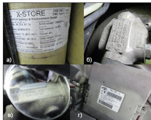
Слика 5 - Провера података уређаја и опреме приликом контролног прегледа (а) резервоар, б) мултивентил, в) редуктор, г) електронска контролна јединица) [15]
