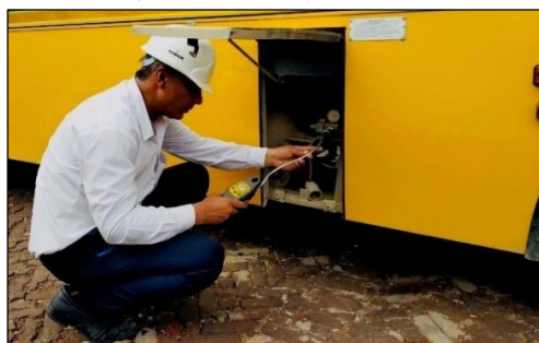
Слика 6 - Провера цурења гаса из система за КПП на возилу [16]
