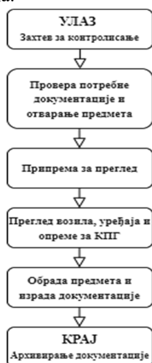
Слика 2 - Дијаграм процедуре контролног прегледа уређаја и опреме за КПП
