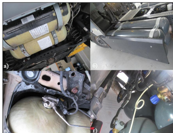
Слика 7. Провера уградње резервоара и његове опреме (а) и (в) резервоар и мултивентил путничког возила, (б) и (г) резервоар и мултивентил теретног возила) [15]
