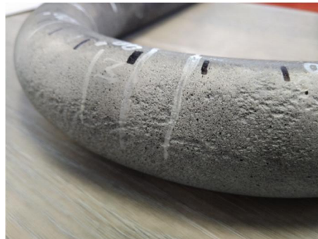
Slika 2 - Oštećenja na temenu cevnog luka u vidu kratera usled dejstva gasne korozije
