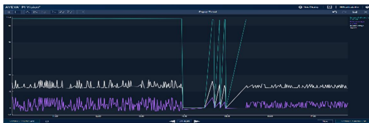
Slika 3 - Dijagram frekvencije, snage motora i jačine struje motora pre i posle balansiranja kačaljke
