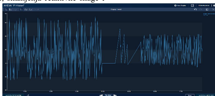
Slika 4 - Dijagram obrtnog momenta motora pre i posle balansiranja kačaljke
