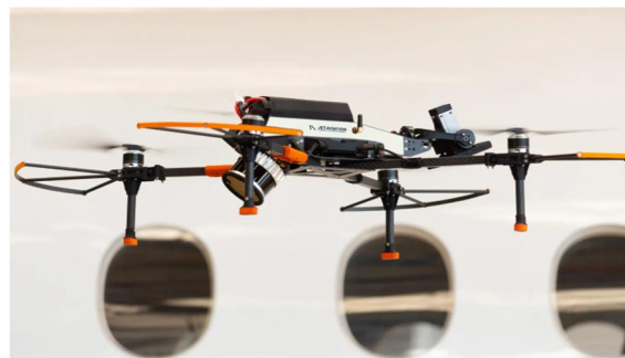
Slika 2 - Autonomni dron u fazi pregleda vazduhoplova, izvor: [19]
