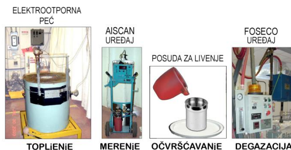
Slika 2 – Korišćeni uređaji i redosled eksperimentalnih koraka
