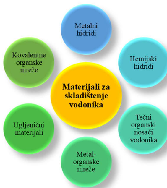
Slika 2 - Pregled materijala za skladištenje vodonika u čvrstom stanju
