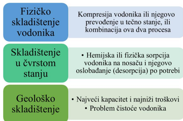
Slika 1 - Pregled metoda za skladištenje vodonika
