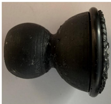
Slika 10 – Gotov zamenski deo sa gumenim prstenom
