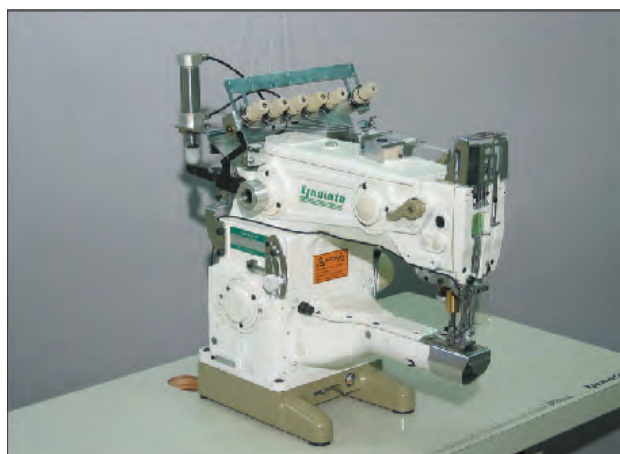
Figure 5: Feed-up-the-arm interlock with 4 needles Slika 5: Mašina ravnih šavova sa feed-up-the-arm radnom površinom
