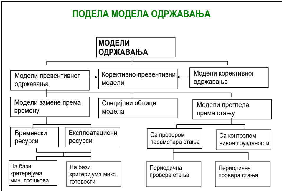
Слика 1 – Модел одржавања техничких система
