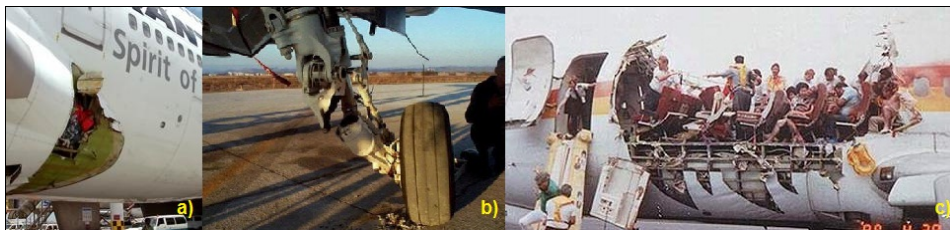
Slika 1 – Oštećenja nastala pod dejstvom korozije: a) oštećenje oplata aviona Boeing 747-400 kompanije "Qantas", 25. jula 2008.godine; b) oštećenje noge stajnog trapa aviona; c) oštećenje aviona Aloha Airlines Flight 243, 28. april 1988.godine
