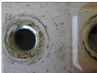
Slika 12 – Korozija u zazoru na avionu Tornado Рис.12 – Щелевая коррозия на самолете Tornado Figure 12 – Crevice corrosion on Tornado
