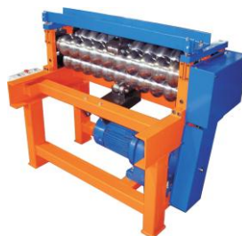
Slika 6 – Primer profilirke za lučno savijanje valovitog lima od 3D modela do originala
