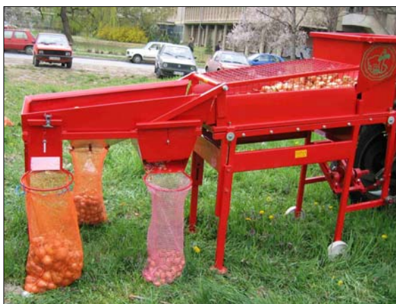
Sl. 4. nova mašina za čišćenje, sortiranje i uvrećavanje lukovica crnog luka
