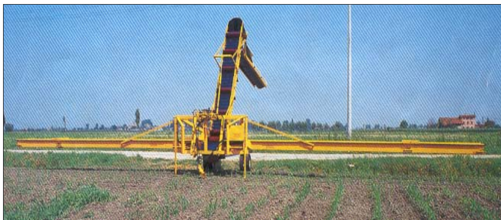
Sl. 3. Mašina za polumehanizovanu berbu začinske paprike
