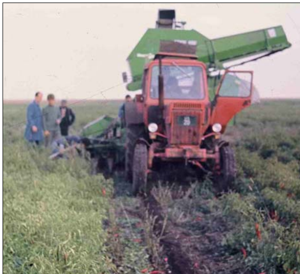
Sl.2. Vučeni dvoredni kombajn RUSTIKA Simplex 2 pri berbi začinske paprike
