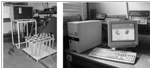
Sl. 2.: Drvena platformica na panelnom segmentu ispred table proporcionalno-integralnog regulatora i računarskom opremom za analizu snimanih podataka.
