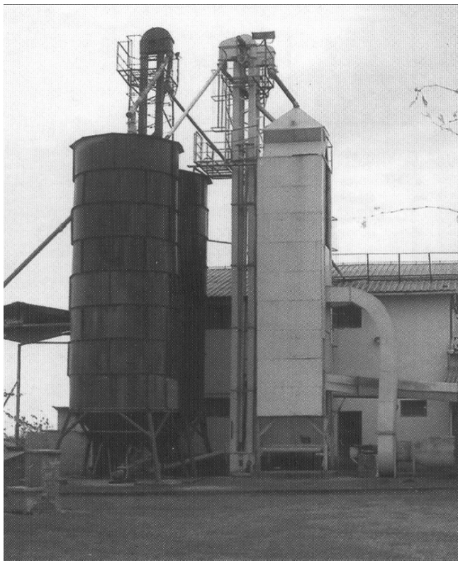
Sl. 2. Vertikalno protočna kolonska sušara »Protein«, Gospodinci
