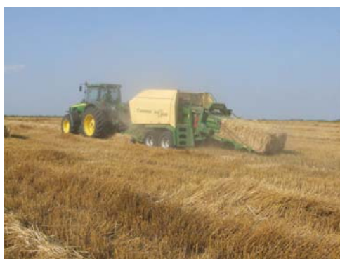
Sl. 3 Nizak prinos slame – visok rez (oko 3,5 t/ha), radna brzina prese 12 km/h (Maglić, 2005)
