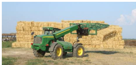
Sl. 8. Savremeni način kamarisanja samohodnim teleskopskim utovarivačem.
