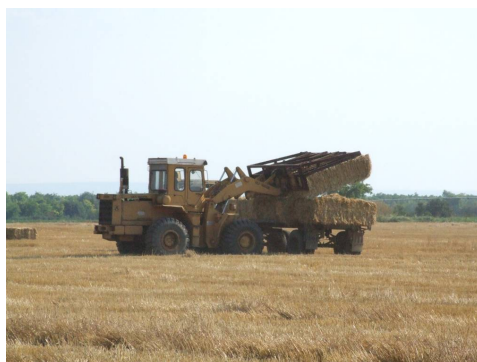
Sl. 6. Efikasnost manipulacije sa slamom maksimalno se postiže samohodnim utovarivačima (2007)
