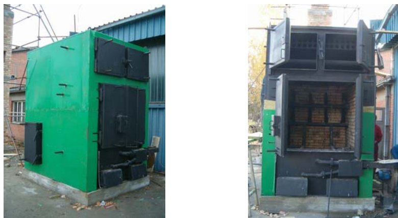
Sl. 1. Kotlovsko postrojenje toplotne snage od 300 kW, proizvođača "Eko produkt" u Novom Sadu
