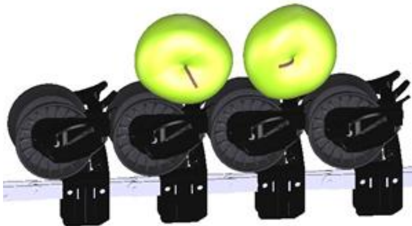
Sl. 6. Transporter jabuke sa elektromagnetom na vagi
