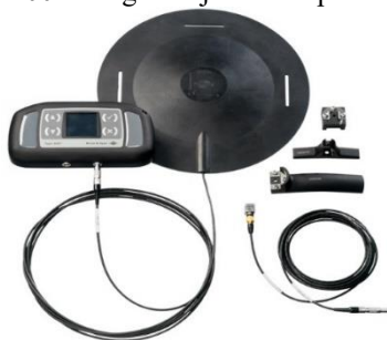
Sl. 4. Instrument za merenje humanih vibracija firme Brüel & Kjær tip 4447 Fig. 4. An Instrument for human vibration measurements firme Brüel & Kjær type 4447
