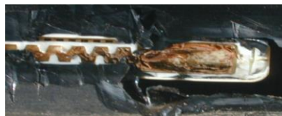
Sl. 2. Ulazak korenovog sistema u kapljač kod navodnjavanja subirigacijom
