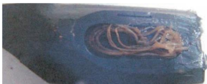
Sl. 2. Ulazak korenovog sistema u kapljač kod navodnjavanja subirigacijom
