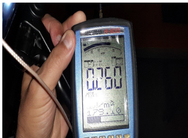
Slika 3a. Primer merenja jačine električnog polja uz pomoć instrumenta Spectran HF 60105
