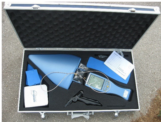
Slika 1. Instrument Spectran HF 60105 za merenje parametara visokofrekventnog elektromagnetnog zračenja
