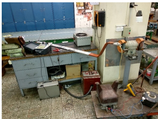
Slika 4. Ispitna šema za VN test rezervnog štapa namotaja statora
