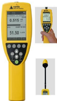
Slika 3. NBM-550 - instrument za merenje električnog polja E sa izotropnom sondom (Probe EF 0691, 100 kHz – 6 GHz).
