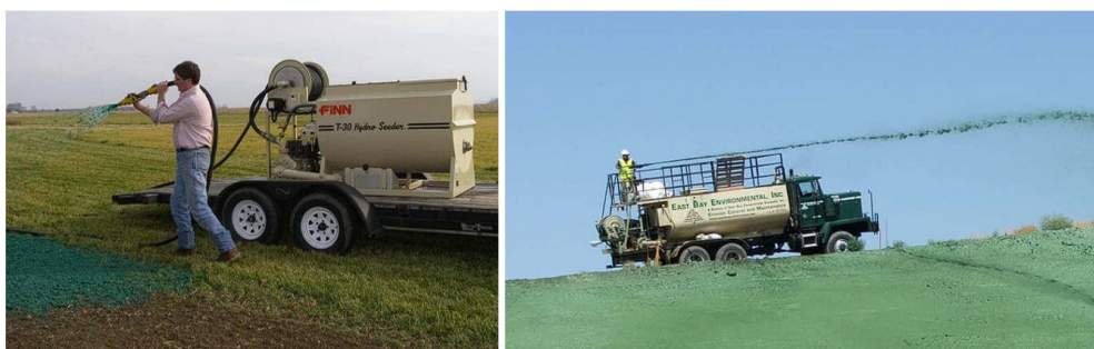
Слика 3. Хидросејалица Т90 са цревом (лево) и хидросејалица Т330 са торњем (десно) ( https://www.finnncorp.com/ )
