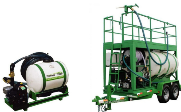
Слика 2: Хидросејалице различитих капацитета резервоара (лево – модел HS-50 запремине 55 галона (208 литара); десно – модел HM-1000-HARV запремине 1000 галона (3785 литара) ( https://turboturf.com/hs-50-p/ ; https://turboturf.com/hm-1000-harv/# )
